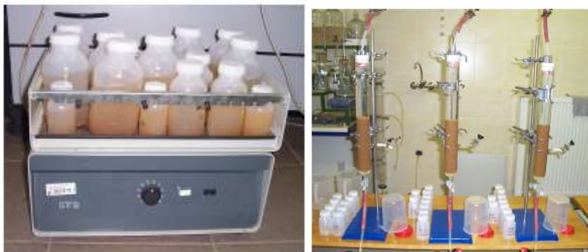
Ilustrační foto: Stanovení sorpčních izoterm prostřednictvím vsádkových experimentů a měření koeficientů disperzivity s pomocí kolonových testů
