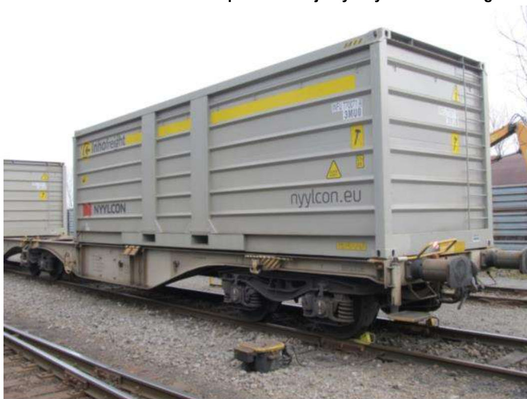
Obrázek č. 9: Převravní kontejnery v systému Innofreight
