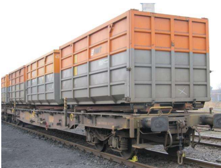
Obrázek č. 8: Převavní kontejnery v systému ACTS
