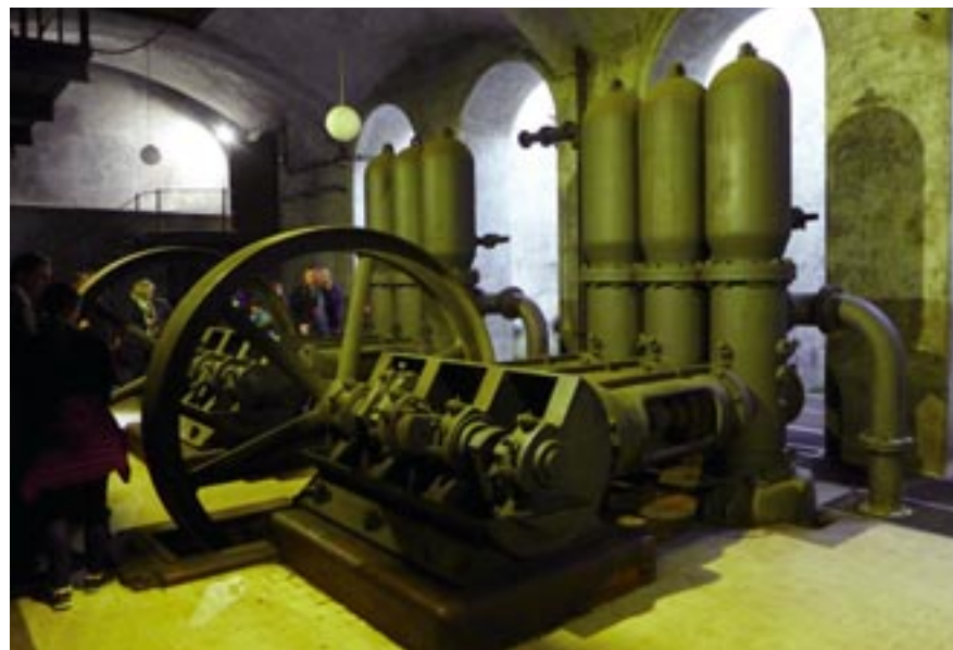
Odstředivá povodňová čerpadla na dolní etáži hlavní strojovny. Chybějí řemeny pro pohon od transmise.
