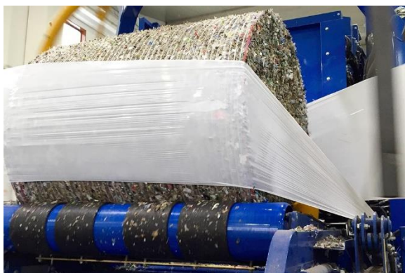
Příklad balení slisovaného odpadu
