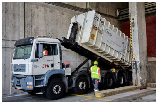
Vysypání kontejneru do bunkru ZEVO
