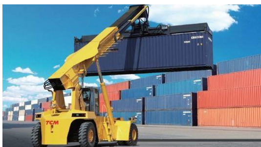
Závěsný systém tzv. Reach-Stacker – nejčastěji využívaný systém. Na snímku při překládce 40' kontejneru
