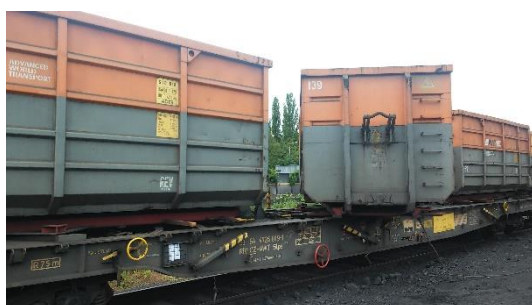
Vytočený kontejner připravený k překládce na automobilový nosič
