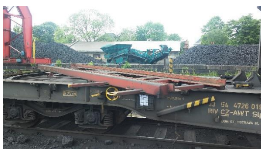
Vagónový nosič připravený k naložení kontejneru
