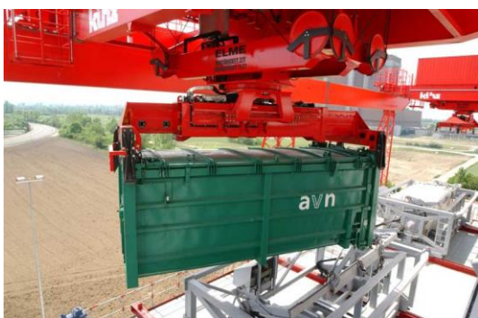
Doprava automatizovaným systémem k zásobníku odpadu
