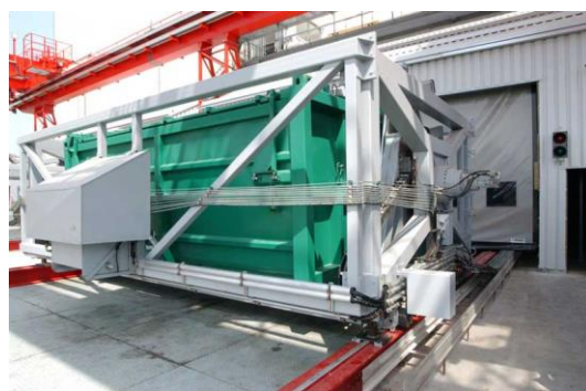
Specializované zařízení, které kontejner otevře a vysype do bunkru
